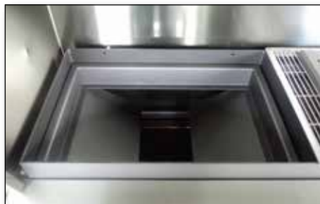
châssis dans les bac à charbon avec déflecteurs
