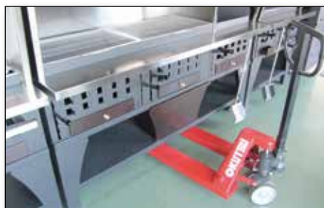
insertion élévateur au-dessous du gril en position centrale
