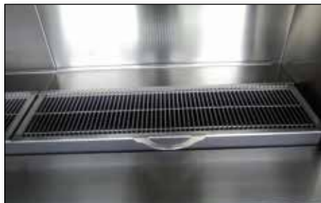
grille de cuisson standard monté sur un bac linéaire pour brochettes
